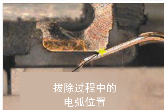
图1：在“擦拭”区域产生的电弧位置位于最终插入到位的Z-MAX®触点位置之外
