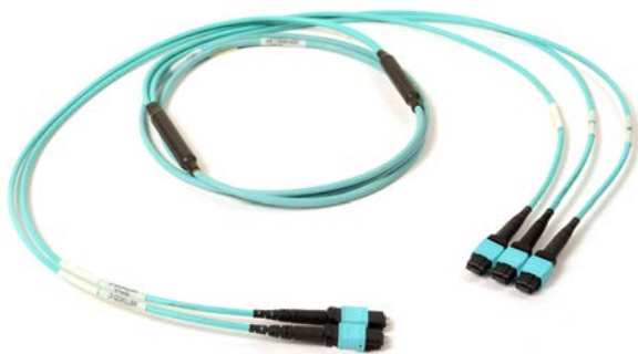
FIGURA 4: Los cables de conversión de equipo 40/100 Gb/s que hacen la transición de dos conectores MTP de 12 fibras de baja pérdida desde el backbone a tres conectores MTP de 8 fibras de baja pérdida para equipo ofrecen 100 % de utilización de la fibra óptica en aplicaciones de 40 y 100 Gb/s.
